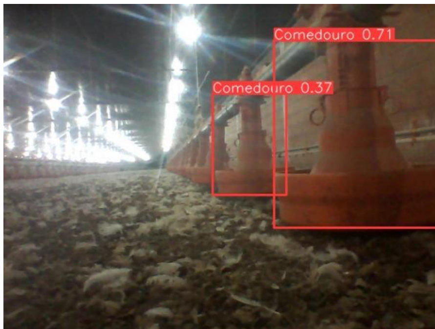
Figura 4. Detecção dos comedouros por visão computacional. Fonte: Cardoso et al. (2023).
