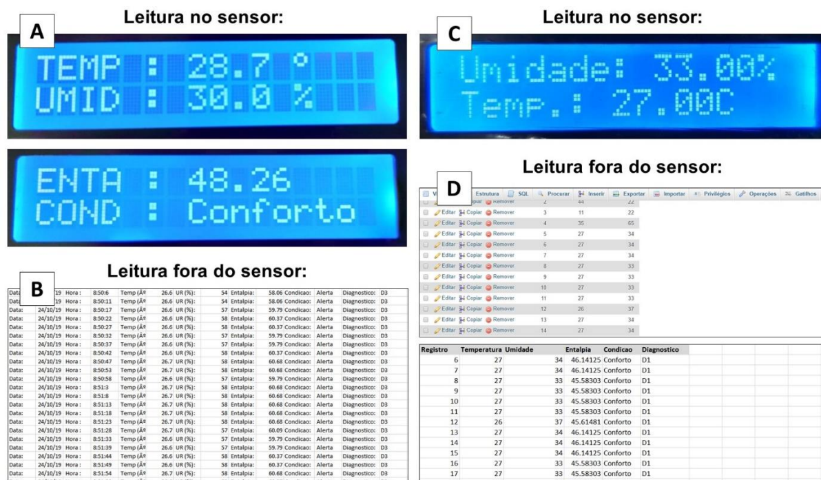
Figura 15. Ferramentas de leitura de dados do S1: no sensor (A) e no Excel (B); e do S2: no sensor (C) e nas planilhas em nuvem e Excel (D).
